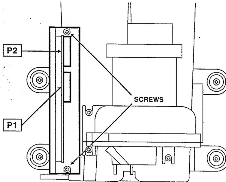
Figure 5-7. Motor Controller
